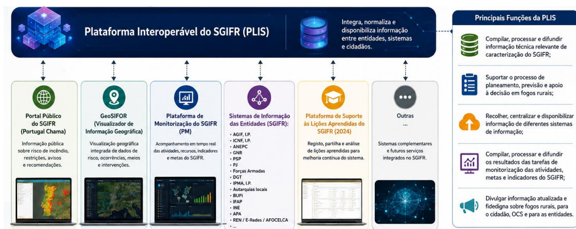
Figura 56. Arquitetura do SIFOR e da Plataforma Interoperável do SGIFR (PLIS), integrando sistemas e plataformas de suporte à gestão integrada de fogos rurais.
